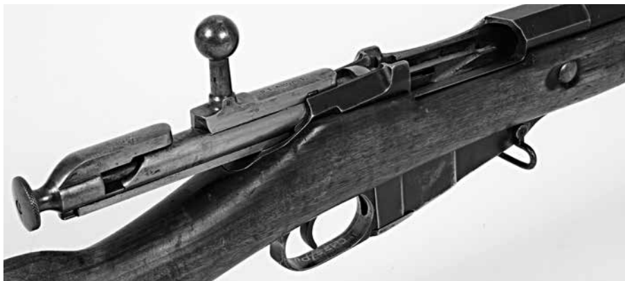
Orosz 7,62 mm-es 1891 M Moszin-Nagant ismétlőpuska nyitott zárszerkezettel 76
