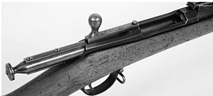
Orosz 10,67 mm-es 1870 M Berdan II egylövetű puská nyitott zárszerkezettel 74
