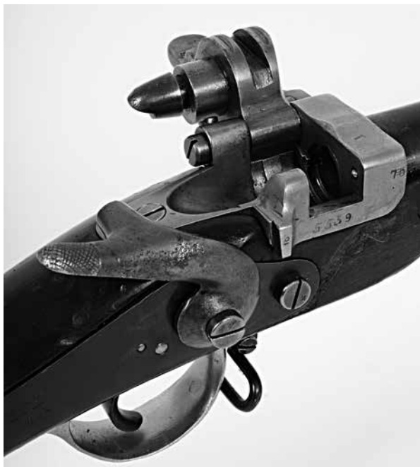
Orosz 1869 M 15,24 mm-es Krnka egylövetű puská nyitott zárszerkezete
